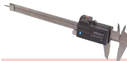
Standard Messschieber mit U-WAVE-TCB (Summer) und Anschlusseinheit
