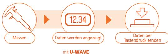
Das **U-WAVE**-System ist eine Lösung zur drahtlosen, effizienten und genauen Übertragung der Daten von Messgeräten wie Messschiebern und Bügelmessschrauben an PCs. Es optimiert die Datenerfassung, reduziert Fehler und steigert die Produktivität bei Qualitätssicherungs- und Prüfprozessen.
