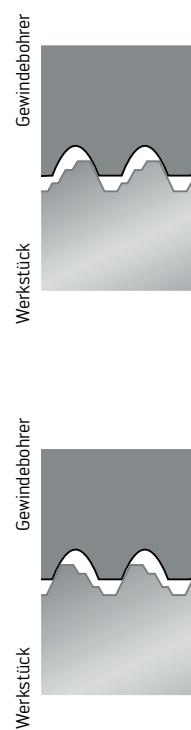
Axial verschneidenes Gewinde bei rechtsgedrehten Werkzeugen: Verschneiden auf der Flankenuntersseite
