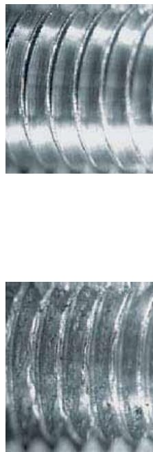
glatte Oberfläche bei hervorragender Schmierung
