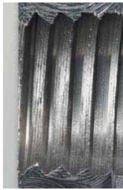
Axial verschnittenes Durchgangsgewinde
