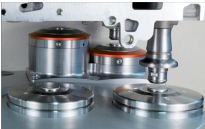
Werkstück mit mehreren Spann- und Auflagepunkten
