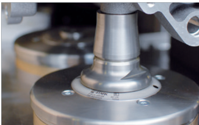
Positionsflexibles Spannelement in x/y/z-Richtung
