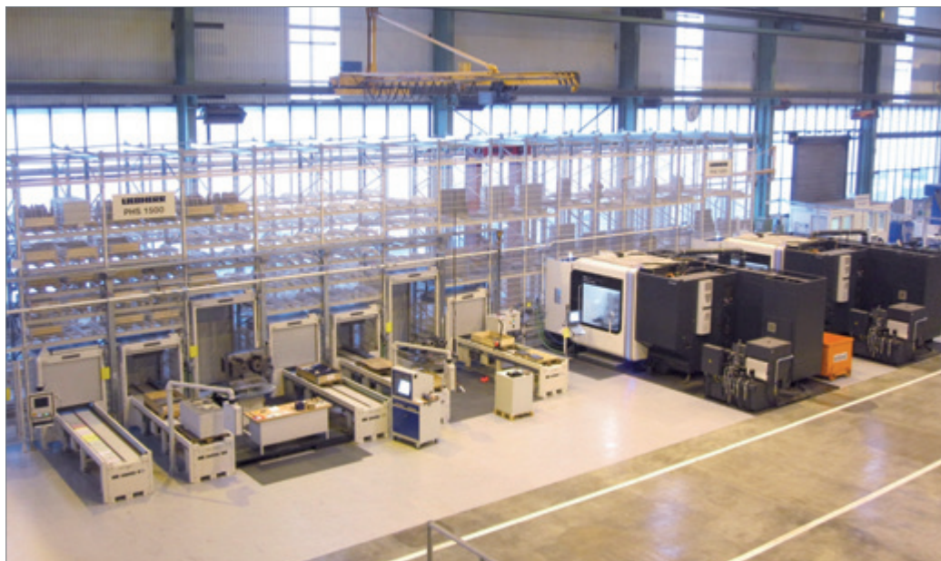
Palettenbahnhof mit über 50 Vorrichtungen
