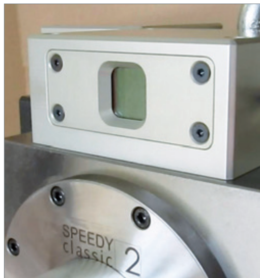
Die grüne Anzeige zeigt, dass richtig gespannt ist.
