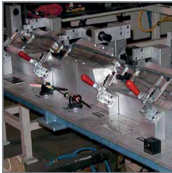
Modell 210-U in einer Prüfvorrichtung
