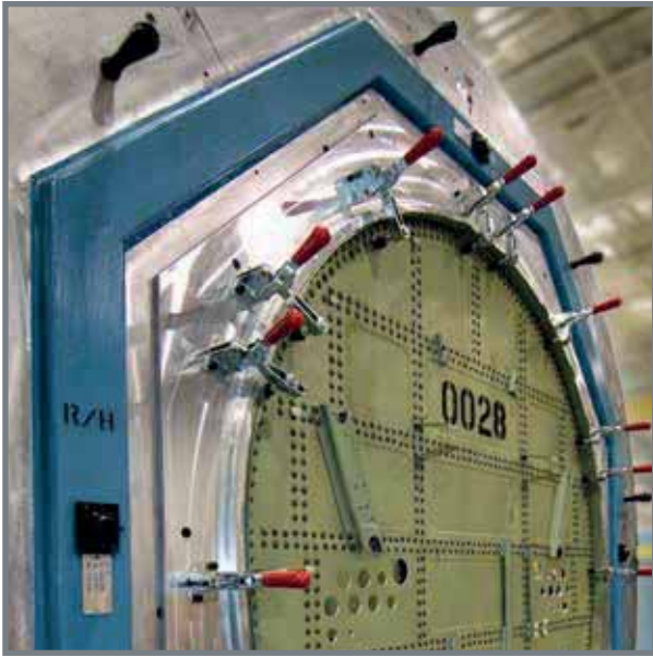
Modell 210-U in einer Montagevorrichtung der Flugzeugindustrie
