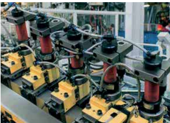
Reihenstanzanlage für Stahlblechteile
