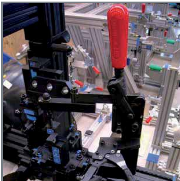
Modell 533-LB und 227-UB in schwarzer Ausführung in einer optischen Prüfvorrichtung
